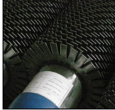
Şekil 5. Ekonomizerlerde Yaygın Olarak Kullanılan Kanat Türleri
